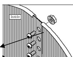
д. Покройте швы и головки болтов липкой лентой 2" (50 мм).
