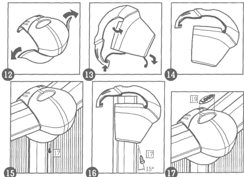
e. **Важно:** .Должен оставаться небольшой промежуток между установленным конектором и стенкой. Конектор не должен касаться стенки. Если конектор касается стенки, открутите болты и снимите конектор. Совместите отверстия поручня с другими отверстиями пластины от центра бассейна. Зафиксируйте это болтами и установите конектор.
