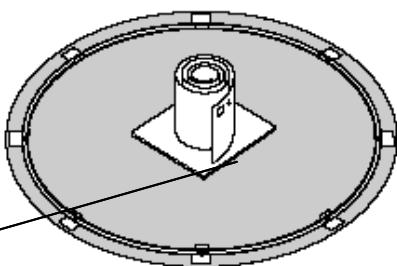
в. Разматывая стенку, направляйте ее основанием в пазы поручней. Первый край стенки нужно установить в крепежную пластину. Окна скиммера и возврата воды должны быть на месте установки фильтра и насоса.
