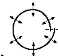
в. соедините края стенки болтами. Головки болтов должны быть внутри бассейна, гайки снаружи.
