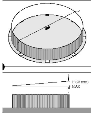
. Используя рулетку, измерьте расстояние до каждой крепежной пластины основания перпендикулярно диаметру окружности. Выравнивайте стенку, двигая ногой крепежные пластины.
